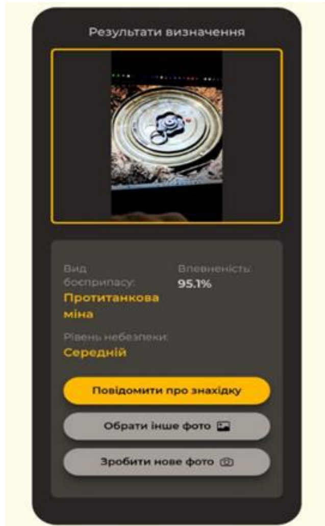
Рис. 3. Результат роботи модуля комп'ютерного зору: успішна ідентифікація протитанкової міни з розрахунком рівня впевненості
